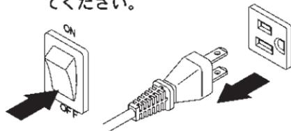
9. 入力ケーブルを取外す場合は、必ずバッテリー側の接続を外してから作
